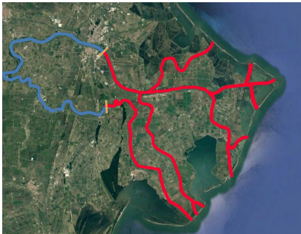
Figura 7: Rappresentazione dell'attuale risalita del cuneo salino nel Delta del fiume Po in condizione di alta marea (in rosso)
